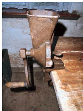
Der er ligesom en lille kværn indeni og så er der hul i bunden, hvor produktet der forarbejdes forlader maskinen.
